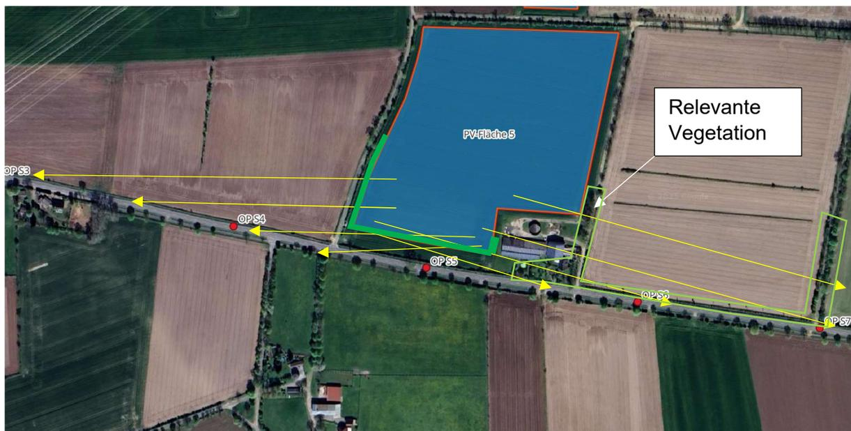
Abbildung 16: Geometrisch mögliche Reflexionen auf die L 28 und Position empfohlener Sichtschutz (Annahme: Relevante Vegetation bleibt erhalten)
